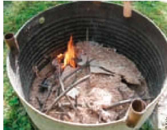
Keramikobjekte wurden in einer Tonne mit Sägespänen aufgeschichtet. Dann wird das Feuer darüber entzündet.
