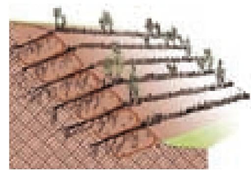
Für **Geotextilwalzen** wird Mutterboden oder Unterboden schichtenweise in Geotextilbahnen eingepackt. Zwischen die einzelnen Erdpackungen werden Weidenbuschlagen gelegt, die austreiben und mit ihren Wurzeln langfristig die Böschungssicherung übernehmen.
